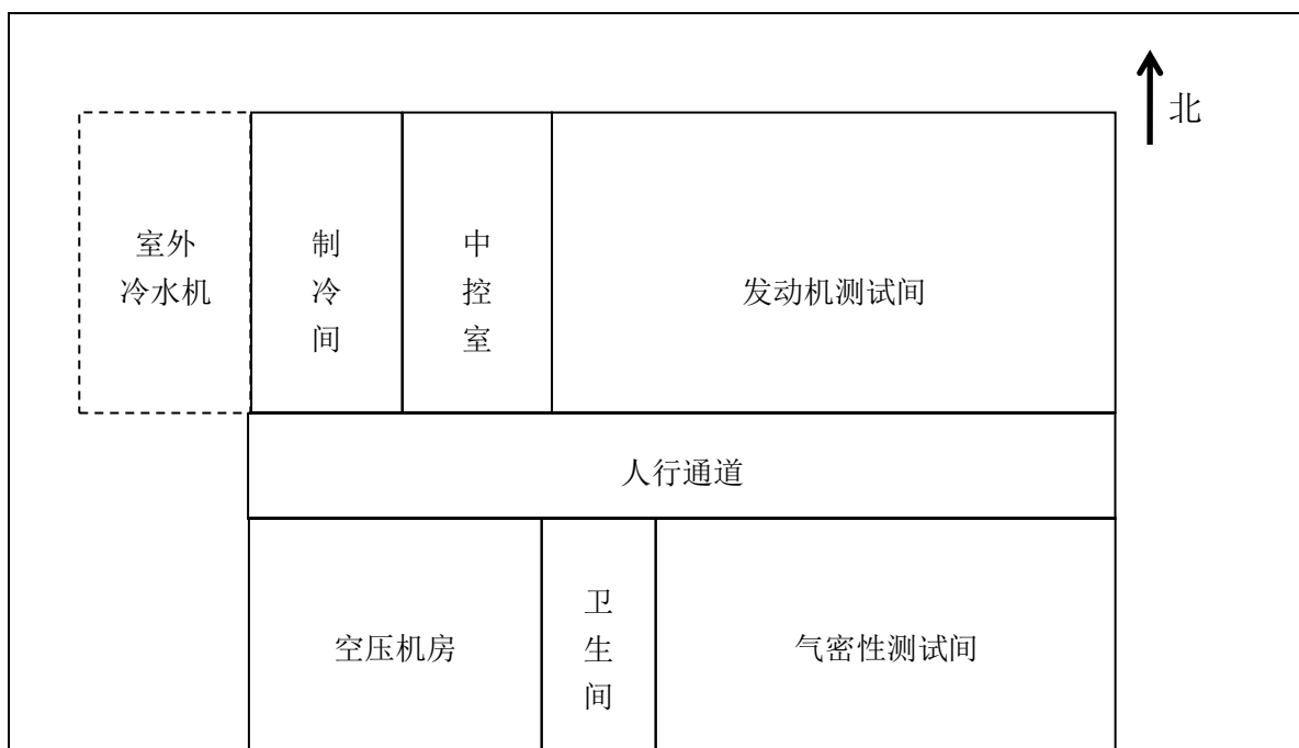
图 4 氢燃料电池试验厂房平面布置示意图
